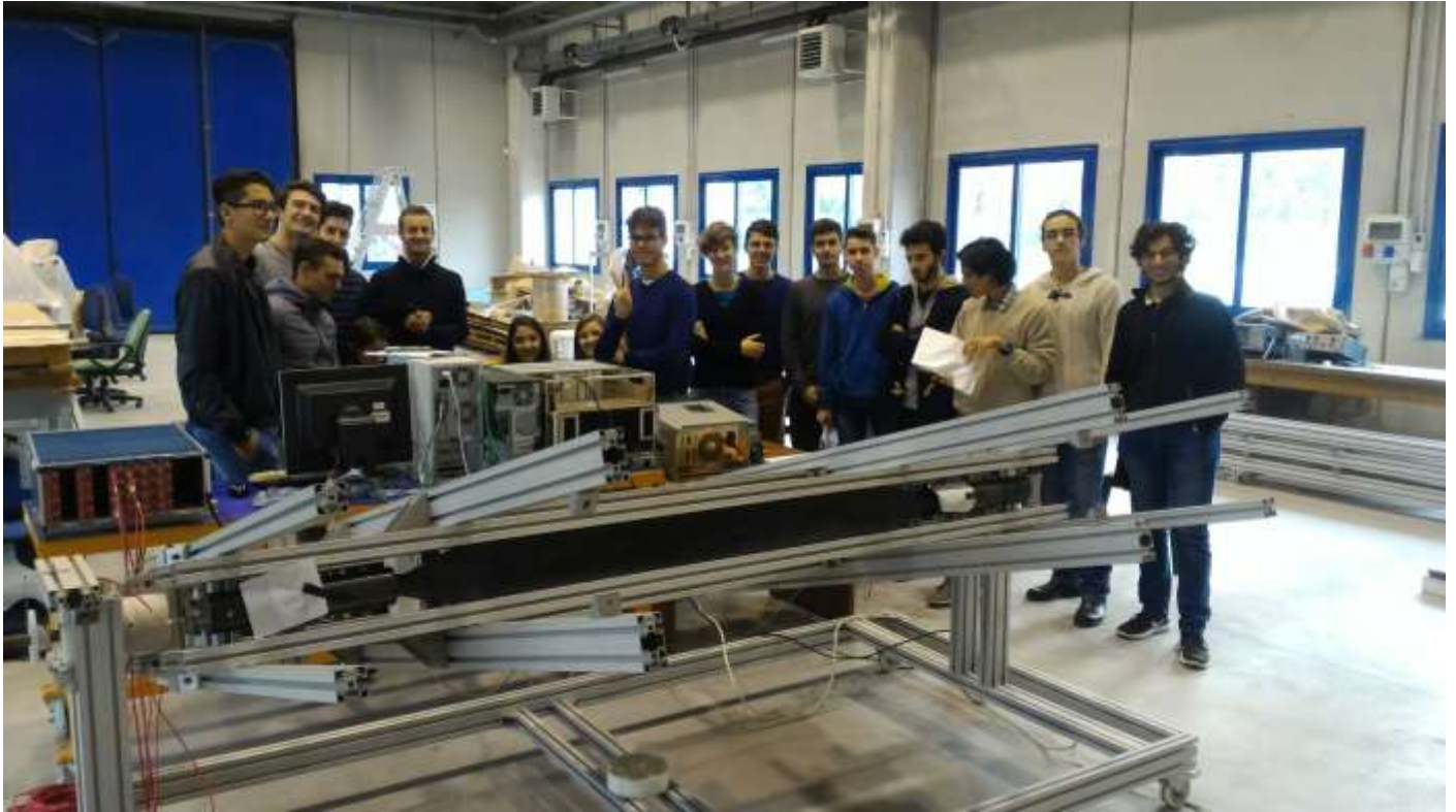
Figura 3 Al telescopio è stata data una determinata inclinazione per modificare il flusso di muoni che attraversano le lastre.
